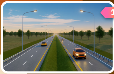
ทางหลวง 4 ช่องจราจร เกาะกลางแบบกดเป็นร่อง (Depressed Median)
